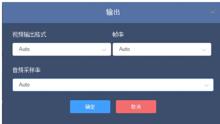
**⚠ 注意：**N40 在解码输出 4K P25/30 时采用 4:2:2 编码，如视频源 4K P25/30 格式采用 4:2:0 编码，解码输出时将以 4:2:0 方式自动适配输出 4K P50/60 格式。
